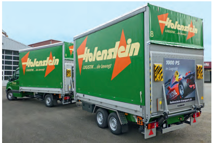
Bei 3,5-Tönnern zählt jedes Kilogramm: Mit einer Hebebühne von geringem Eigengewicht gewinnt man wertvolle Nutzlast.
